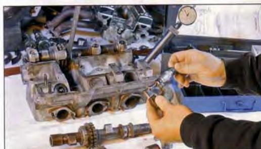
Weniger mühsam fällt dem Mechaniker das **Einstellen der Ventile**, wenn der **Sechszylindermotor** ausgebaut ist
