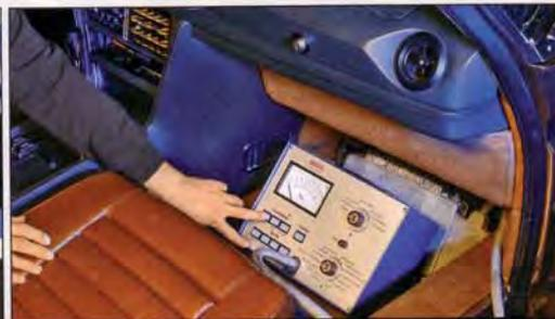
Um die korrekte **Funktion der D-Jetronic** in den späteren **Einspritz-Modellen** zu checken, bedarf es eines speziellen **Testgeräts**
