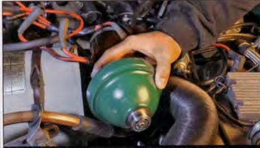
Recht einfach gestaltet sich ein **Wechsel der Federkugeln**. Nach **Druckabbau** im System werden sie einfach **weggeschraubt**
