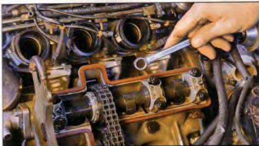
Regelmäßig sollte die **Spannung der Steuerketten** geprüft werden. Die **Sekundärketten** lassen sich bei eingebautem Motor erreichen
