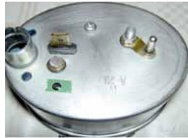
Sieht es so wie auf dem Foto aus, können wir wieder die Messinghülsen in die Gummilöcher stecken und die Schrauben eindrehen. Danach wirkt die Uhr nahezu unangetastet, nichts an den Anschlüssen oder Originalschrauben wurde verändert:
