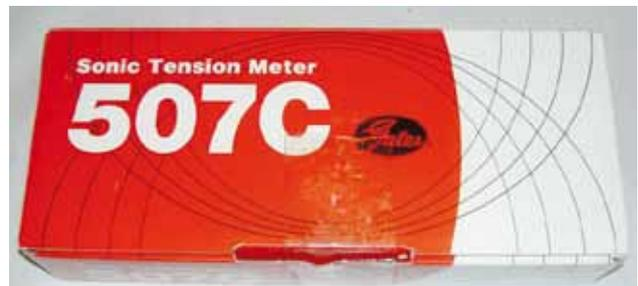
Jetzt kommt die Überraschung: Dieses elektronische Spezialgerät misst die Spannung des Keilriemens nicht etwa mechanisch, sondern akustisch(!), daher auch der Name „Sonic Tension Meter“.
