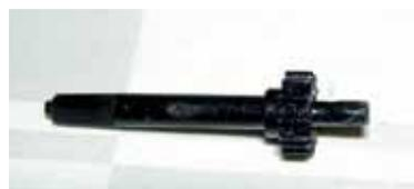
Die Achse der Quarzuhr ist aus Plastik und ohne die zugehörige Aufsteckkappe zu wackelig, als dass wir den originalen Plastikknopf aufsetzen könnten. Also müssen wir etwas mit Originalteilen basteln. Wir bauen die Metallachse des
