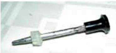
In die Mitte bohren wir ein kleines Loch (kleiner als die Metallachse), erwärmen das Ritzel leicht
