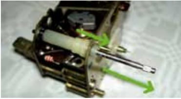
Nachdem wir Achse ausgebaut haben, kürzen wir sie auf der Laufwerkseite soweit, dass die gekürzte Metallachse ungefähr 4 mm länger ist, als der Plastik-Justageregler der Quarzuhr.
