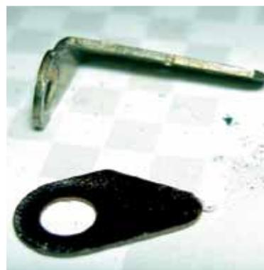
Mit einem Lötkolben entfernen wir das Lötauge und ziehen dabei die Lasche vom Uhrengewehäuse. Mit dabei ist auch die kleine Isolationsplatte, die wir ebenfalls sehr gut gebrauchen können.
