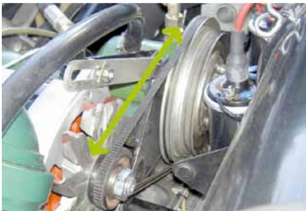
Wem das alles zu aufwändig ist, der legt einfach ein Maßband an den Keilriemen und misst den frei schwingenden Oberteil des Keilriemens per Hand nach (Bild oben), geht im Zweifelsfall schneller und ist ebenfalls genau, wenn man es richtig macht!
