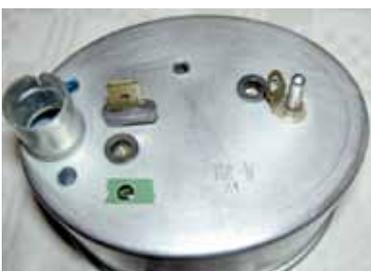
Mit diesen Puffern lässt sich das Uhrwerk nur sehr stramm in die Dose schieben, was die Stabilität erhöht. Hat man alles richtig gemacht, sind alle Ge-
