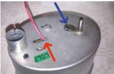
Das schwarze Minuskabel löten wir direkt an die Metalllasche der Gehäuserückseite neben dem Stift (blauer Pfeil), an das rote Pluskabel crimpen
