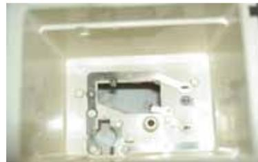
Nun zieht man auch hier vorsichtig(!) Die Zeiger von der Achse und löst das eingeklemmte Ziffernblatt aus dem Werk:
