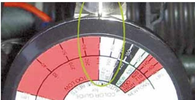
Das Prinzip ist mit Abstand das einfachste aller Spannungsmesser: Man klemmt den Haken an den Keilriemen, dieser passt sich automatisch der Dicke an und am Ziffernblatt kann man bequem die Spannung ablesen, der Wert oben gilt.
