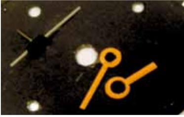
Nachdem die Farbe ausgehärtet ist können die Zeiger eingesetzt werden, und zwar so, dass alle auf 12 Uhr zeigen. Nach einem
