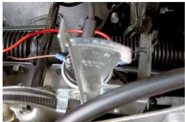
Den KM128 setzt man genauso an, wie den Gates150, da er aber nicht über so eine praktische Klemmfeder verfügt, muss man die linke Lasche beim Messen mit einem Finger auf dem Keilriemen halten (Kreis).
