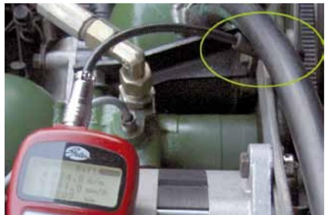
Nun zupft man an dem Keilriemen und wenige Sekunden später piept das Messgerät und zeigt einem die Spannung direkt in Newton an.
