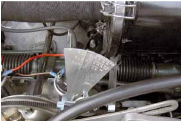
Aufgrund der ganzen Kabel und Aggregate im Motorraum des SM ist es gar nicht so einfach, diesen knappen Berührungspunkt zu treffen, die Handhabung wird dadurch umständlich und man sollte gegebenenfalls die ganze Prozedur zwei oder dreimal wiederholen. Hat man den „Sweet Spot“ erreicht, lässt man den Druckteller langsam wieder los und kann nun die Keilriemenspannung an der Anzeigenadel ablesen, die an entsprechender Stelle stehen geblieben ist.
