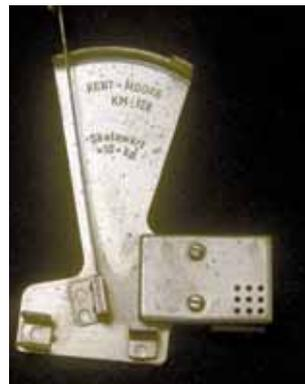
Das Messgerät hat den Vorteil, dass es über einen kleinen Drucksensor verfügt, der bei Berühren des Keilriemens eine kleine Tröte aktiviert: Man hört also, wenn der „Sweet Spot“ erreicht ist. Auch das Ablesen ist praktischer, denn die Skala befindet sich auf der Oberseite des Messgeräts.
