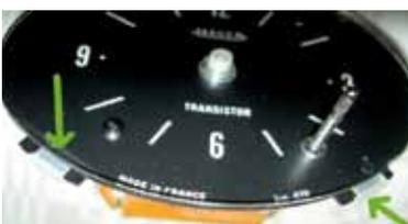
Jetzt kann es (endlich) an den finalen Zusammenbau gehen: Wir schrauben die Ziffernblätter an das Quarzwerk (aufpassen, dass kein Staub dazwischen kommt!!) und setzen die kleinen Plastikpuffer, die wir hoffentlich beim Zerlegen nicht verloren haben, auf die Kanten des ovalen Blechs.
