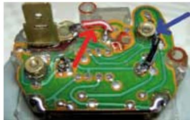
Mit dieser Verkabelung bezieht das Quarzwerk seinen Strom und Masse durch dieselben Außenkontakte, wie das originale Uhrwerk.
