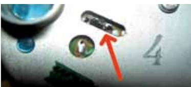
montieren. Dazu setzen wir das Laufwerk mitsamt den Ziffernblättern in das Gehäuse ein und markieren mit einem dünnen schwarzen Marker den Schlitz der Pluspol-Lasche und die Schraubenlöcher:
