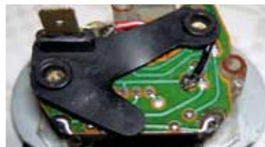
Passt alles, klemmen wir das Gummi wieder in die Metalldose ein, es ist darauf zu achten, dass die Gummi-Ösen komplett durch die Löcher gesteckt werden, bis sie „einrasten“. Nun kommen wir zu einem weiteren Detail, das wir an der Uhr „originalisieren“ wollen, den Justageregler für die Uhrzeit:
