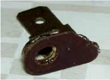
Mit gutem(!) Komponenten-Epoxydharzkleber verkleben wir die Lasche mit der Isolation, denn ein Schutz vor Kurzschlüssen ist wichtig!
