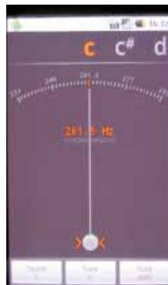
Eingesetzt in obige Formel ( $F = 4 \times 0,024 \text{kg} \times 1 \times (0,205 \text{m})^2 \times (261,5 \text{Hz})^2$ ) ergibt dies eine Keilriemenspannung von 275N, beinahe haargenau das Ergebnis des €600.- teuren Gates Spannungsmessers. Unglaublich, es funktioniert!!
