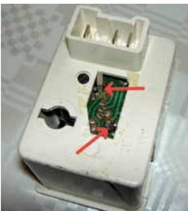
Das Ablöten ist einfacher als es klingt, danach kann das Uhrwerk leicht aus dem Plastikgehäuse gezogen werden.
