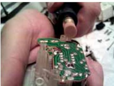
Das Ziffernblatt verwenden wir nun als Bohrschablone und bohren mit Hilfe des Dremels und eines kleinen Bohreinsatzes zwei winzig kleine Löcher in die Plexifront des neuen Uhrwerkes. Diese müssen so klein
