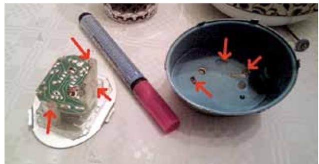
Da die Schraubenlöcher der Dose nicht mit den Gewinden des neuen Uhrwerkes übereinstimmen, müssen wir ein neues Loch an der richtigen Stelle bohren. Um die richtige Stelle zu finden, tragen wir mit einem Lackstift etwas Farbe auf die Gewindehülsen des Uhrwerkes und setzen dieses richtig in die Dose ein. Dies markiert die möglichen Bohrstellen auf dem Blech:
