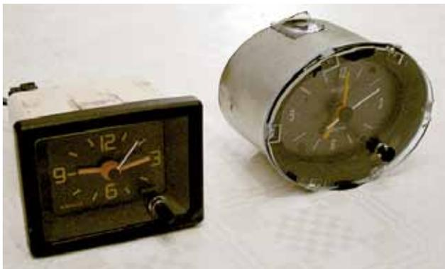
Im direkten Vergleich zur originalen SM-Uhr zeigt sich, dass die Kienzle-Uhr in ihren Abmessungen, mit dem ovalen Ziffernblatt und den schmalen, orange-farbenen Zeigern eine sehr gute Ausgangsbasis für einen Wechsel darstellt. Also, auf geht's ...
