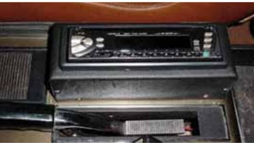
Viele haben sich daher normale Radios mit 180 mm Einbautiefe besorgt und entsprechende Aufsätze für die Mittelkonsole konstruiert und angefertigt.
