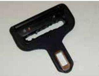
Jetzt ist das Gurtband „nackt“ und kann mit der originalen Gurtmechanik bestückt werden. Bei den Chromschnallen erster Serie muss an diesem langen Ende der männliche Chromstecker aufgeschoben werden.
