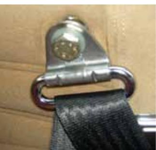
Jetzt muss man nur noch das neu bestückte Gurtband wieder in die Gurtrolle schieben (*Bild oben, richtig herum (grüner Pfeil)!*), den Metallstift wieder in die Schlaufe stecken, den Umlenkbügel wieder an der B-Säule verschrauben und das andere Ende am Schweller verschrauben, schon ist die Umrüstung (fast) fertig.
