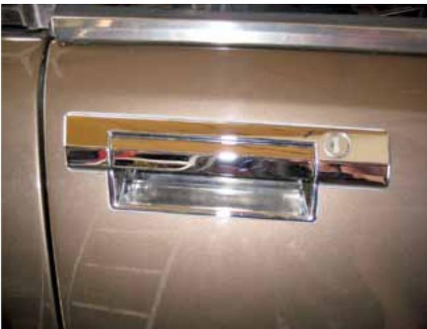
Die Bohrungen für die Gelenkachse Griff-Gehäuse müssen auf 5 mm aufgebohrt werden und die Befestigungslöcher in der Tür müssen 1 ein 2 mm nach unten aufgefeilt werden.
