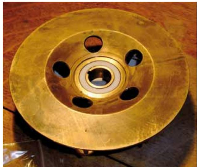
Dieses ergibt, zusammen mit dem 360°-Kontakttring, ein mutmaßlich sehr lang haltendes System. Ich empfehle diesen Weg aber nur mit einer neuen Dichtung zusammen, denn durch den geringen Abrieb der Keramik auf dem Karbon dauert es SEHR lange, bis eine alte, eingelaufene Dichtung wirklich dicht wird.
