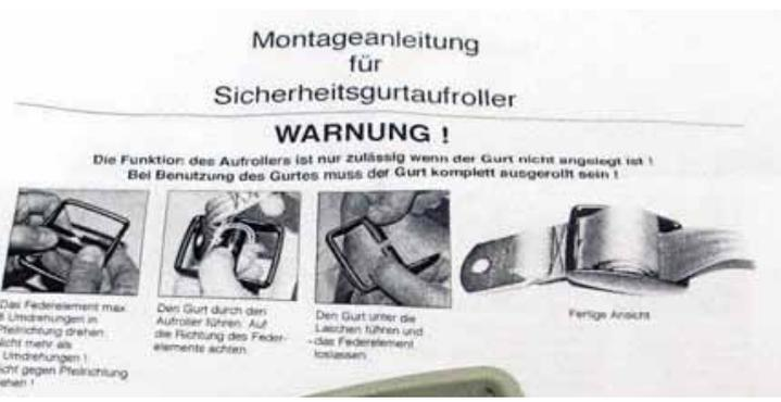
Leider lässt die Qualität der Wickler ein wenig zu wünschen übrig: Wenn man die Achse bei der Installation überdreht, springt die Feder sofort heraus. Man kann die Achse des Wicklers umbauen und verstärken, aber eine Anleitung dafür würde hier zu weit gehen. Man muss halt einfach vorsichtig bei der Installation sein.
